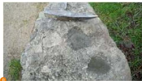
Fig. 26 - A – Construção em alvenaria de brecha magmática. B – Aspeto de uma brecha magmática, onde são evidentes os clastos que a compõem.
