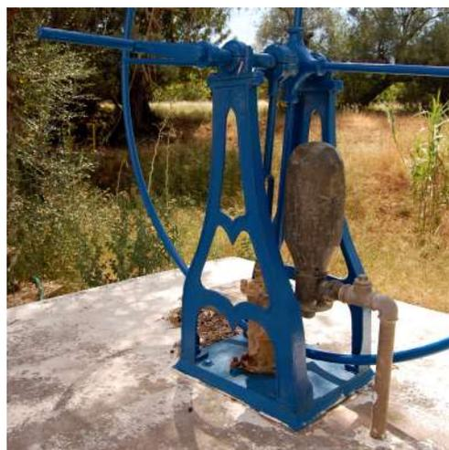
Fig. 80 - Roda com câmara de ar
